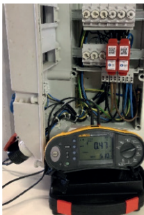
Schleifenimpedanz-messung an einem Unterverteiler mit CEE 16 Adapter, gemessen mit einem Prüfgerät nach DIN EN 61557-3 (VDE0413-3), (herstellernabhängig einsetzbar)
